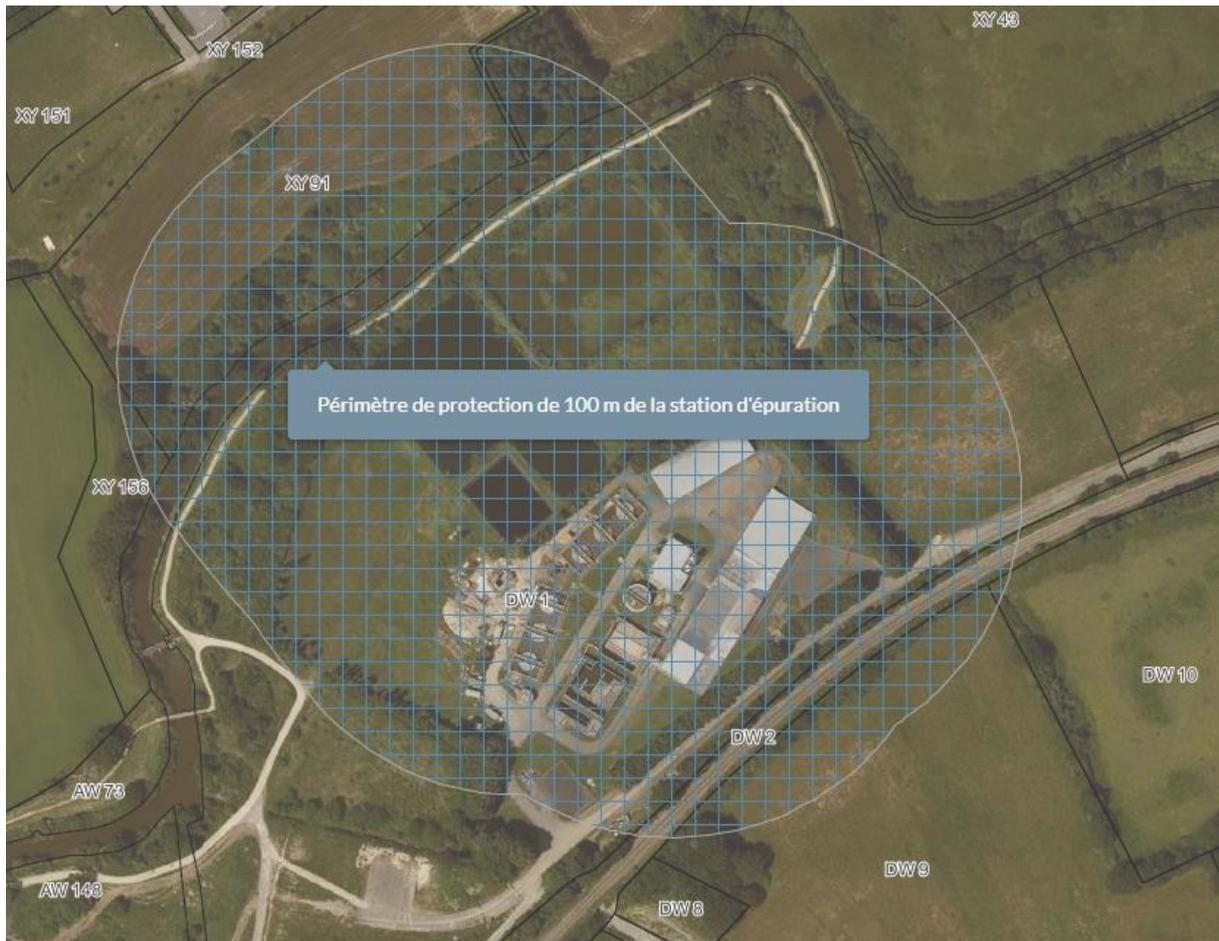
Figure 6 : Périmètre de protection autour de la station d'épuration
