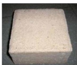
Pavés en béton poreux
