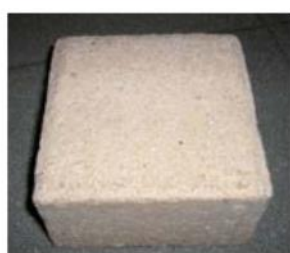
Pavés en béton poreux
