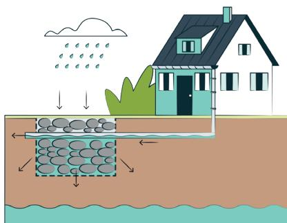
Fosse allongée remplie de gravier qui permet à l'eau de pluie de s'infiltrer dans le sol.
